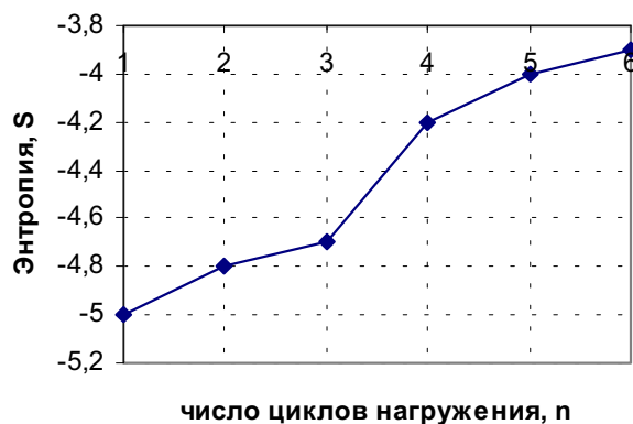
Рис. 3. в - Зависимость энтропии S от числа циклов нагружения; алевролит, ш. 3. - Донбасская, гл. 480 м «кубик»
